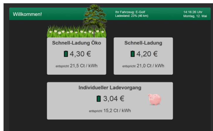
Abbildung 6: Interface zur Nutzerinteraktion bzw. Auswahl verschiedener Ladestrategien für den Ladevorgang im Parkhaus.
