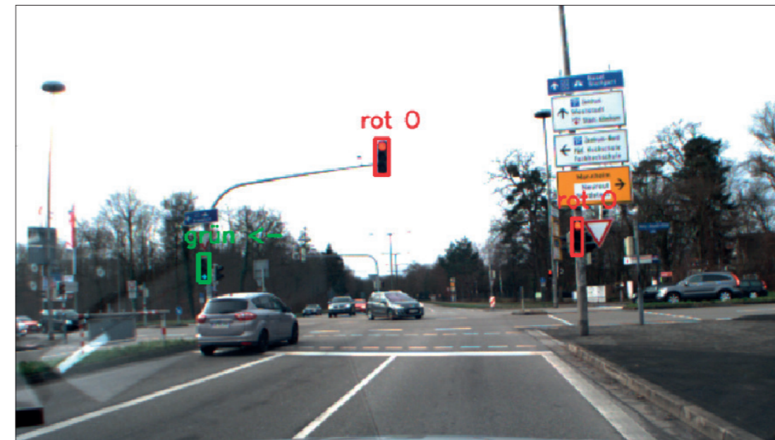
Originalaufnahme mit annotierten Ampelzuständen aus dem Versuchsträger.
