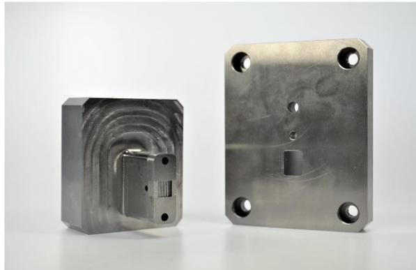
Abbildung 25: Die Werkzeugeinsätze ermöglichen das Einpassen eines Nickeleinsatzes mittels Vakuumhalterung. Auf der Gegenseite ist ein Werkzeugeinsatz eingearbeitet, welcher eine optische Oberfläche mit einer Rauheit kleiner 20 nm aufweist.
