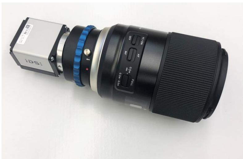
Abbildung 28: Hyperspektraler Funktionsdemonstrator, bestehend aus IDS UI-3000-SE-M-GL Kamera, einfaches Aluminium-Drehteil als Adapter, Novoflex MFT Adapter zur Blendensteuerung und Tamron 90 mm Objektiv.
