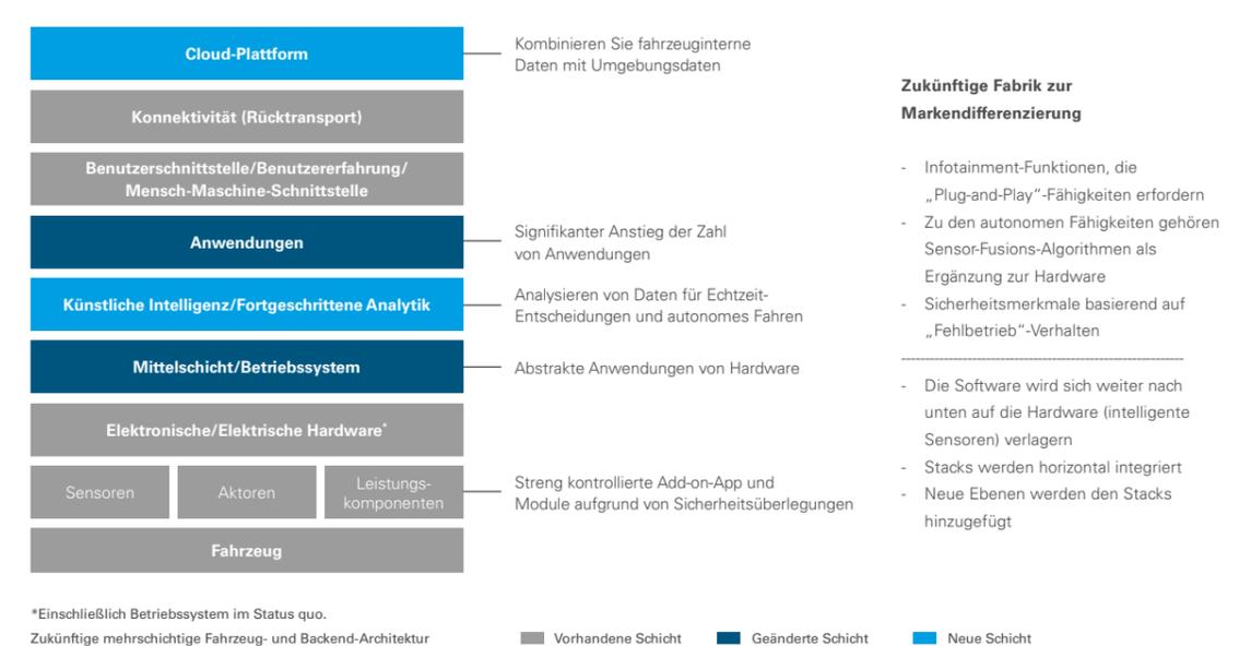
Abbildung 4: Die zukünftig neuen und veränderten Ebenen einer leistungsfähigen E/E-Architektur
