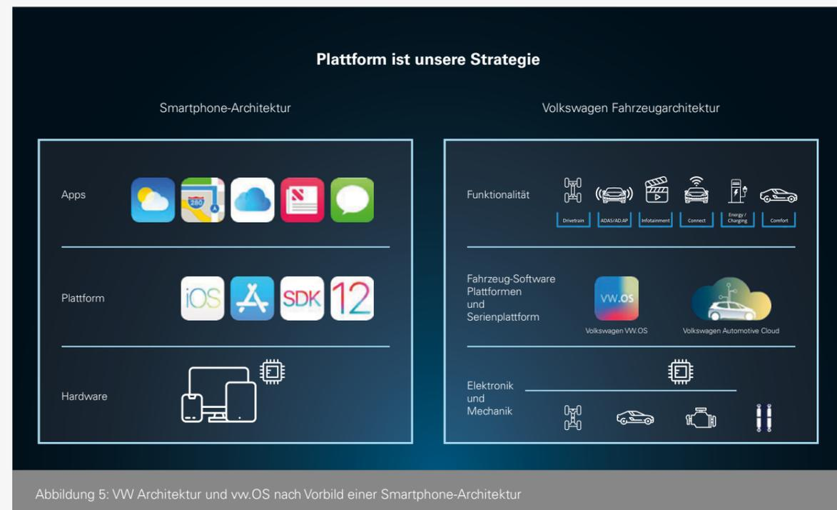
Abbildung 5: VW Architektur und vw.OS nach Vorbild einer Smartphone-Architektur
