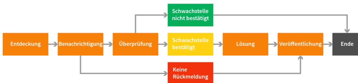
Abbildung 1 Ablauf eines Coordinated / Responsible Disclosure Prozesses<sup>88</sup>
