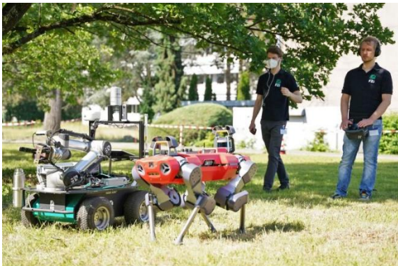
Die Fähigkeit zur Gefahrstoffbergung live demonstriert: das mobile Roboterteam des FZI Forschungszentrum Informatik. Bild: © Fraunhofer IOSB
