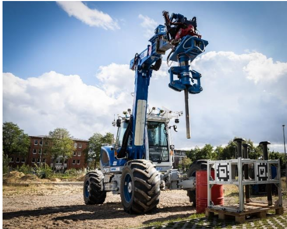
Schreitbagger ARTER entnimmt eine Bodenprobe auf dem DFKI-Außengelände (im Hintergrund der mobile Leitstand). Bild: © DFKI, Annemarie Popp
